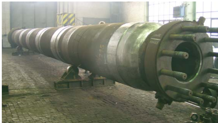
Obr. 1 - Chemický reaktor rok výroby 1942. Priemer ~1250 mm, hrúbka steny 100-120 mm
