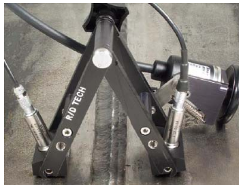
Obr.12 Detail ručného skenera pre kontrolu zvaru metódou TOFD
