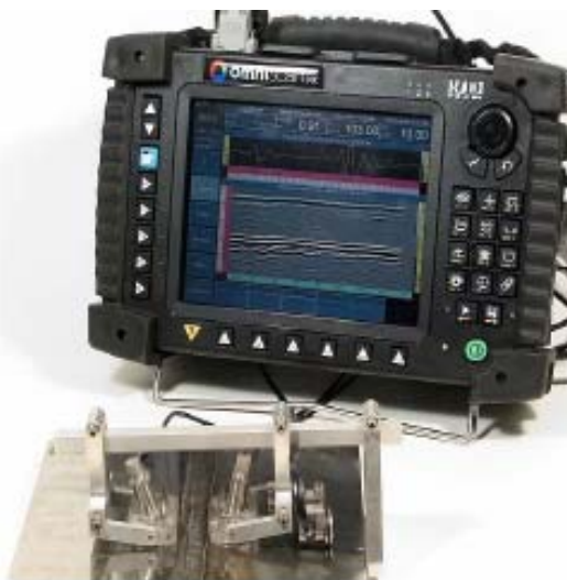
Obr.10 Prenosný prístroj Omniscan s ručným skenerom pre kontrolu zvaru metódou TOFD
