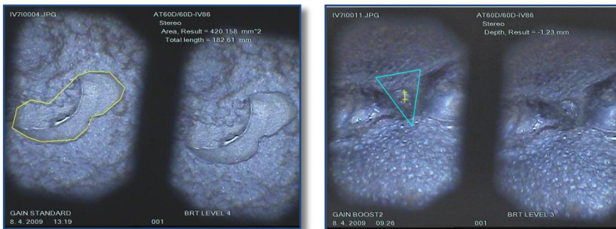
Obr. č. 9 a 10: Ukážka merania „veľkosti“ ( plochy ) neželaného kusu materiálu na vnútornom povrchu a hĺbky neprievaru ( obrázok vpravo)
